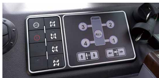
Steering control panel 转向控制面板
